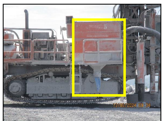
ภาพที่ 2.22 รถเจาะรูระเบิดที่ติดตั้งอุปกรณ์กำจัดฝุ่นที่ออกมาจากการเจาะรูระเบิด
