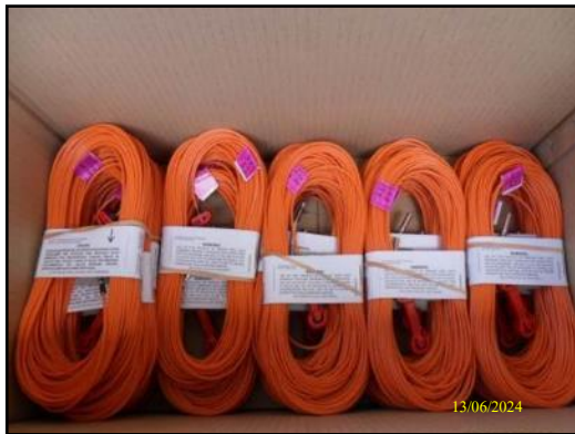
ภาพที่ 2.18 การใช้แก๊ปช่วงเวลาเพื่อควบคุมปริมาณวัตถุระเบิดต่อจังหวะการระเบิด ให้มีค่าน้อยกว่า 650 กิโลกรัม/จังหวะถ่วง
