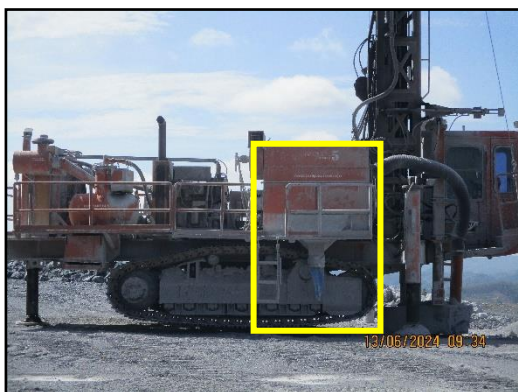
ภาพที่ 2.22 รถเจาะรูระเบิดที่ติดตั้งอุปกรณ์กำจัดฝุ่นที่ออกมาจากการเจาะรูระเบิด
