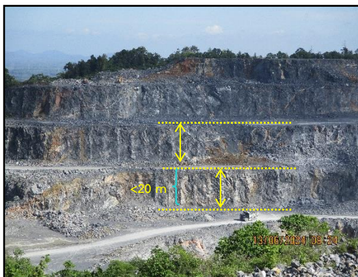
ภาพที่ 2.7 การทำเหมืองแบบขั้นบันได (Benching Method)
