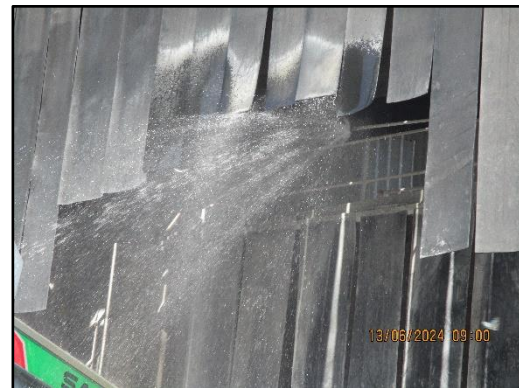
ภาพที่ 2.24 ระบบ Spray น้ำอัดโนมัตในกระบวนการบดย่อยหิน
