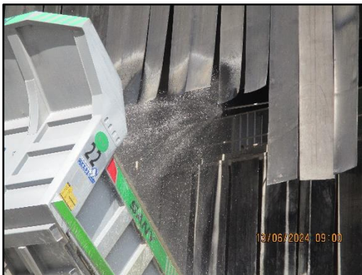
ภาพที่ 2.24 ระบบ Spray น้ำอัดโนมัตในกระบวนการบดย่อยหิน
